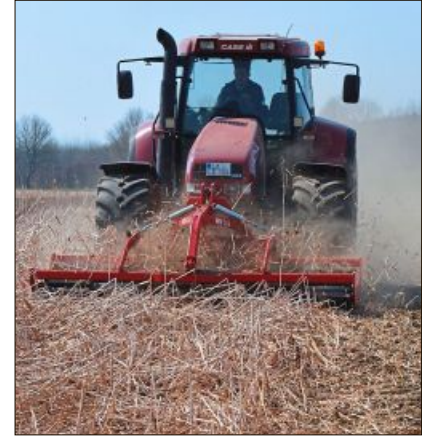
Eine Messerwalze zerkleinert die Zwischenfrucht. Fotos: ak
